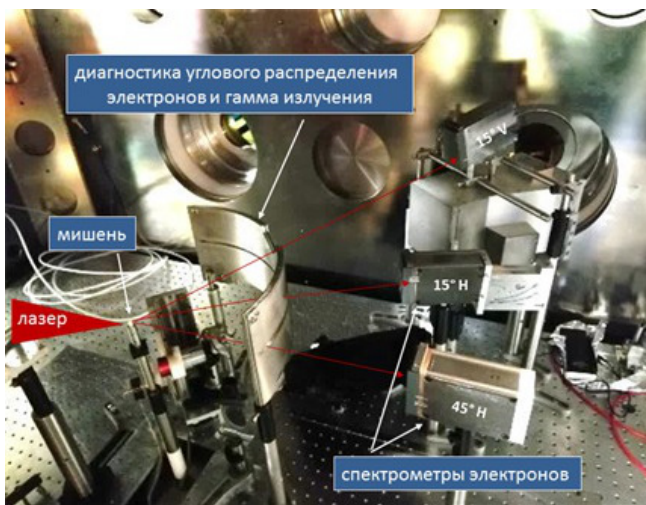
Рисунок 2. Внутри мишенной камеры показано положение мишени, цилиндрической сборки для измерения углового распределения электронов и гамма-излучения, а также магнитные спектрометры, расположенные под разными углами для измерения энергетических спектров ускоренных электронов.
