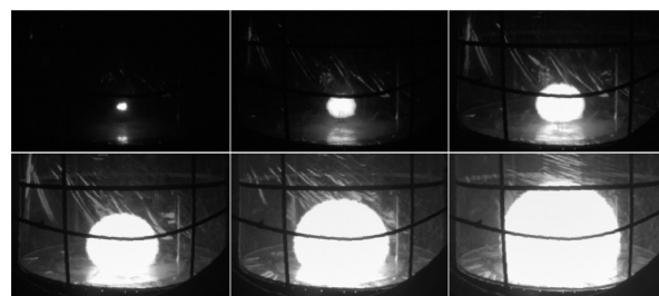
Рисунок 2. Последовательность ИК фотографий распространения фронта пламени над твердой плоской поверхностью в моменты времени 3.33, 16.67, 30, 43.33, 56.67 и 70 мс (слева направо сверху вниз).
