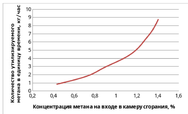
Рисунок 10. Зависимость количества утилизируемого метана в единицу времени от концентрации метана на входе в камеру сгорания.
