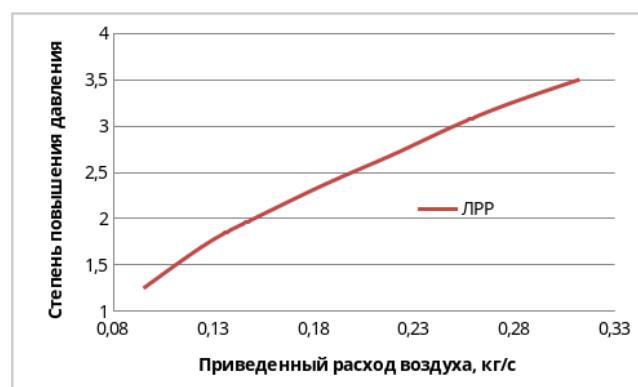
Рисунок 2. Характеристика компрессора ГТГМ03 с линией рабочих режимов (ЛРР).
