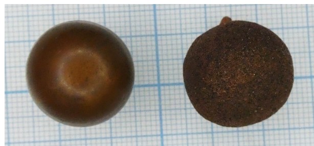
Рисунок 2. Сферические образцы из меди ( d = 22 мм): гладкий (слева) и с покрытием (справа).
