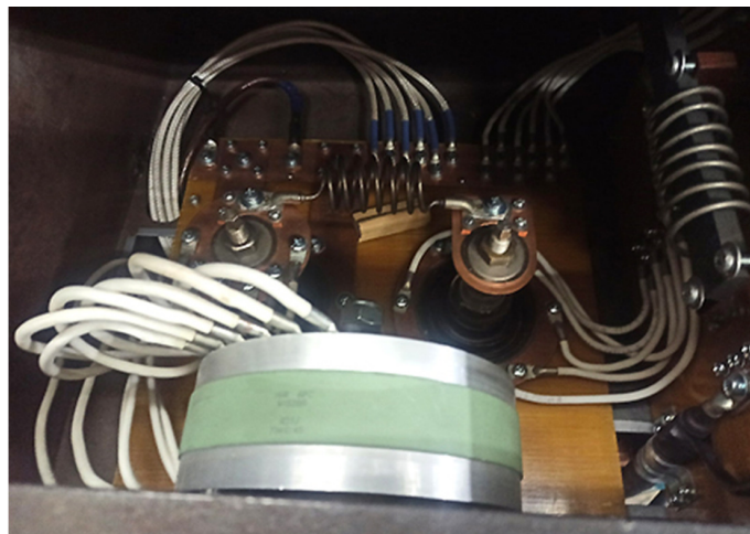
Рисунок 2. Конструкция управляемого игнитронного разрядника.
