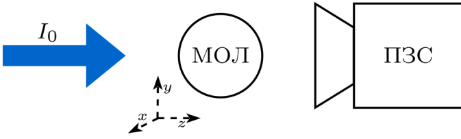
Рисунок 3. Принципиальная схема измерения методом визуализации резонансного поглощения. На атомы, захваченные в МОЛ, направляется зондирующий пучок интенсивностью I_0 . После прохождения сквозь облако пучок с образовавшейся из-за поглощения частицами МОЛ фотонов тенью регистрируется на матрице ПЗС-камеры.
