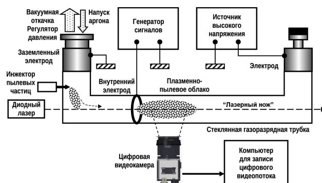
Рисунок 1. Схема эксперимента для исследования плазменно-пылевых волн в газовом разряде постоянного тока.
