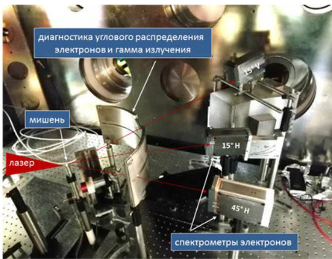
Рисунок 2. Внутри мишенной камеры показано положение мишени, цилиндрическая сборка для измерения углового распределения электронов и гамма-излучения, а также магнитные спектрометры, расположенные под разными углами для измерения энергетических спектров ускоренных электронов.
