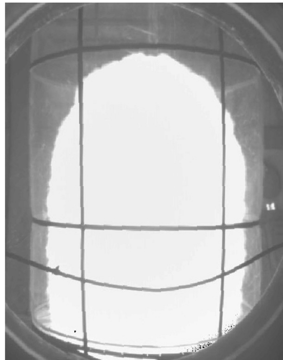
Рисунок 3. ИК фотография фронта пламени над твердой плоской поверхностью в момент времени 100 мс.
