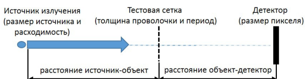
Рисунок 2. Параметры, определяющие геометрию эксперимента по изучению волновых свойств рентгеновского излучения дифракционным методом.
