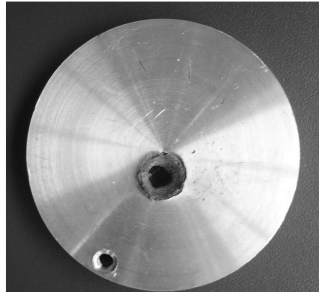
Рисунок 3. Дюралевая мишень после «выстрела», u_p = 3.8 км/с.
